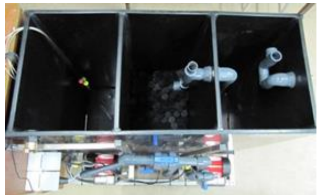
Figuur 16: Bovenaanzicht denitrificatie- en fosfaatfilter
