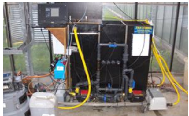
Figuur 15: Proefopstelling van denitrificatie- en fosfaatfilter
